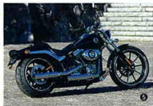
①ウインカーの取り付け位置がハンドルバーからトリブルツリーへと変更されている。②今後は、メーターナセルをタンク上に取り付け、メーターも移設できるように考案中。③まるで違和感なく装着されているボブフェンダー。④テールランプもフェンダー変更に合わせて取り換えられている。⑤太いリアタイヤが強烈なインパクトだが、織細なイメージもある。
