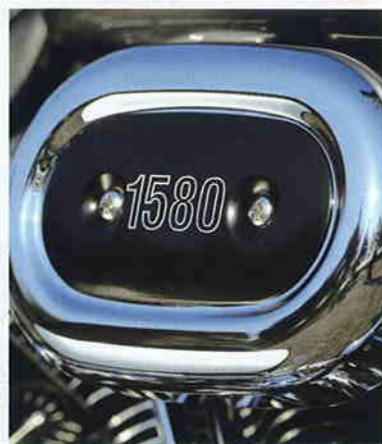
純正のハイフローエアクリナーを使用。排気量を表すインサートの文字は、ショベルヘッド時代の1200ではなく1580になっている。ツインカムエンジンの誇りがここに。
