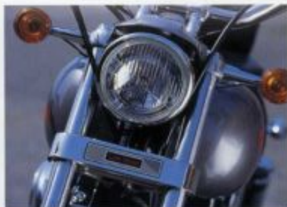
フロントの目を引くポイントが、ワンオフ製作したトリム・カバー。また、ウインカーも昔と同じ位置に移植してある
