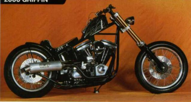
純正加工のストレッチフレームにS&S製EVOモーターを搭載。ワンオフのエキパイにバンス&ハインズのマフラーをセットアップ。レプテックの6速ミッション、さらにはNOSが組み込まれたハイパフォーマンスチョッパーだ。このテキストは、独自のハイパープリンスコといった感じだろうか。なかなか刺激的なカスタムの登場だ。オーナー/西藤剛
